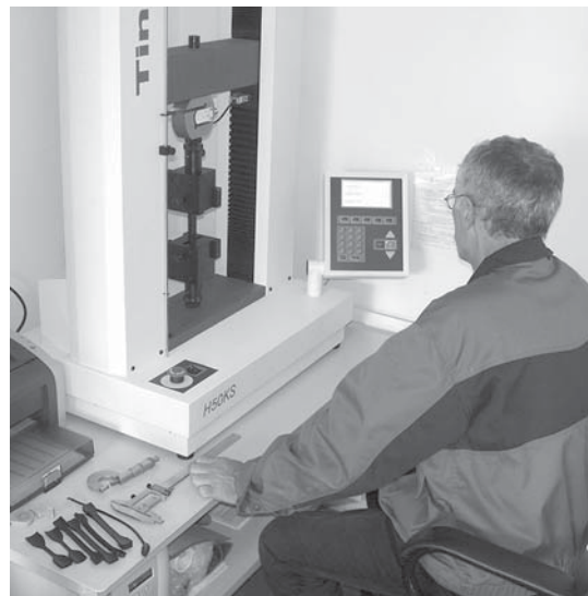
Фото 4.2.8. Испытания стыковых сварных соединений в лаборатории ИКАПЛАСТ
