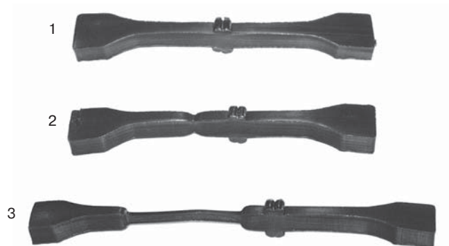
Фото 4.2.9. Образец с фрагментом стыкового сварного соединения (1).
