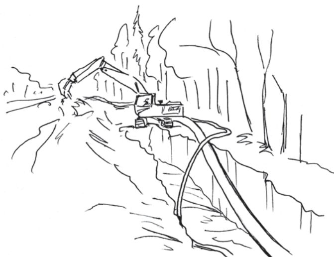
Рис. 4.1.1. Укладка в траншею трубопроводов, смонтированных на поверхности
