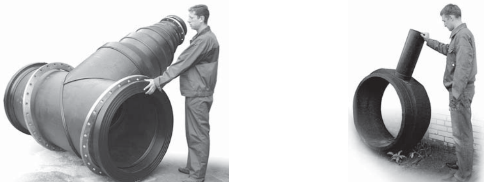
Фото 4.2.3. Примеры соединительных деталей и узлов ИКАПЛАСТ, выполненных сваркой встык. Слева: неравнопроходной тройник 900 x 200 SDR17 ПЭ 100. Справа: тройник ИКАПЛАСТ с монолитным корпусом 1000 x 225 SDR17 ПЭ 100
