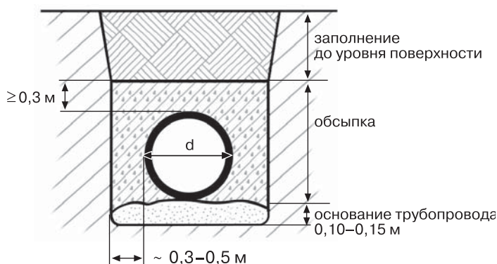
Рис. 4.1. Рекомендуемые параметры профиля траншеи
